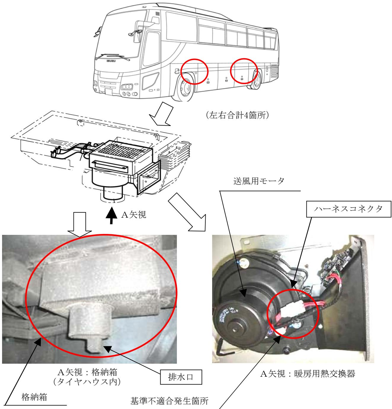
暖房用熱交換器の格納箱の防水構造が不適切なため、融雪剤を含んだ水分が侵入し、熱交換器の送風用モータのハーネスコネクタ部で漏電を起こす場合がある。そのため、そのまま使用を続けると、当該コネクタ部が発熱し、最悪の場合、ハーネスコネクタ部が発火するおそれがある。
