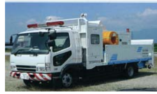
排水ポンプ車
