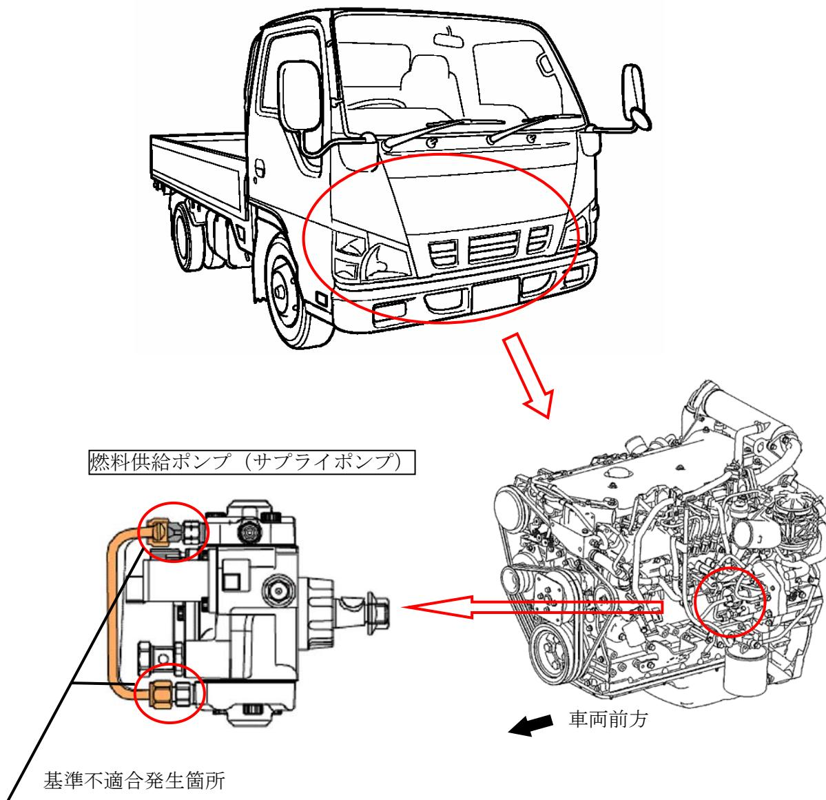
燃料噴射装置の燃料供給ポンプ（サプライポンプ）に接続するパイプのナット締結力が不足しているため、気密の確保が不十分なものがある。そのため、そのままの状態で使用を続けるとパイプ締結部から燃料が漏れるおそれがある。
