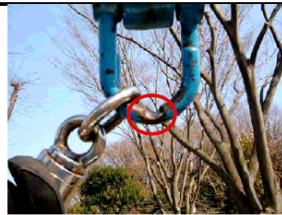
▲ 上部吊金具摩耗
