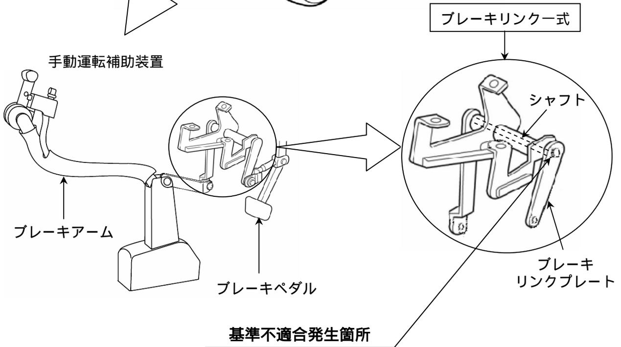
ブレーキペダルを手動で操作するための運転補助装置装着車両において、操作力を伝達するブレーキリンクプレートとシャフトの溶接強度に不十分なものがあるため、車両が停止した状態で、ブレーキアームをさらに押し込むと当該溶接部に過大な力がかかり亀裂が生じる場合がある。そのため、そのまま使用を続けると溶接部の亀裂が進行し、最悪の場合、破断してブレーキが効かなくなるおそれがある。
