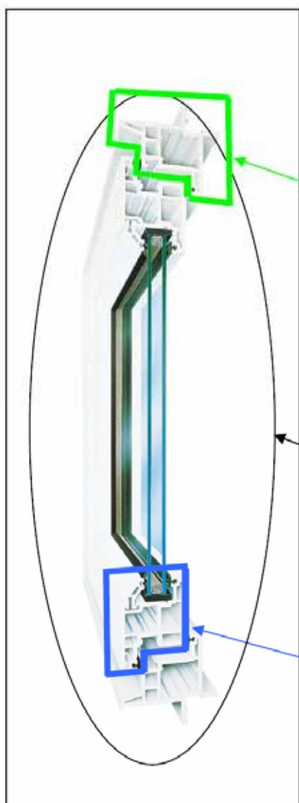
梃： 建具(戸)の周囲にあって、建具(戸)を建て込むために建物に固定された部材。FIX窓においては、ガラスをはめ込むための建物に固定された部材。
