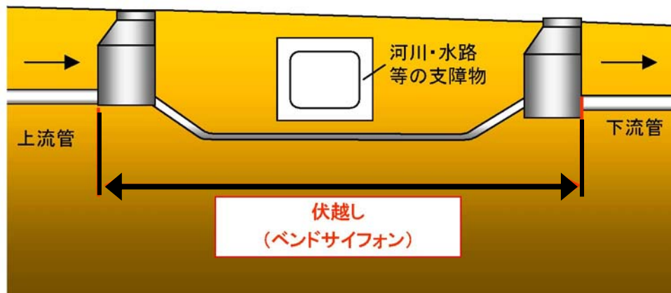
図 改良型伏越し（ベンドサイフォン）のイメージ（クイックプロジェクト）
