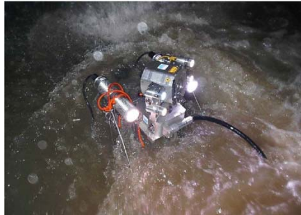
図 流速 1.5m/s でも調査可能なテレビカメラ
