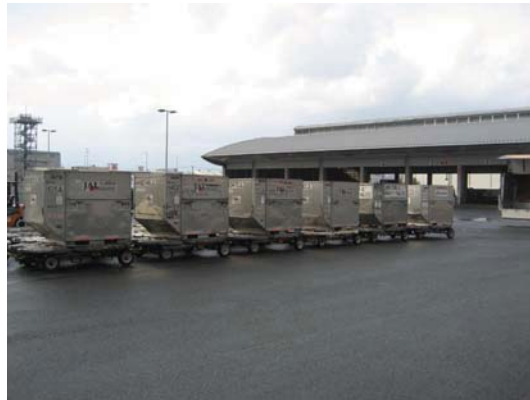
図 2-35 ドーリーにより搬入されたコンテナ
