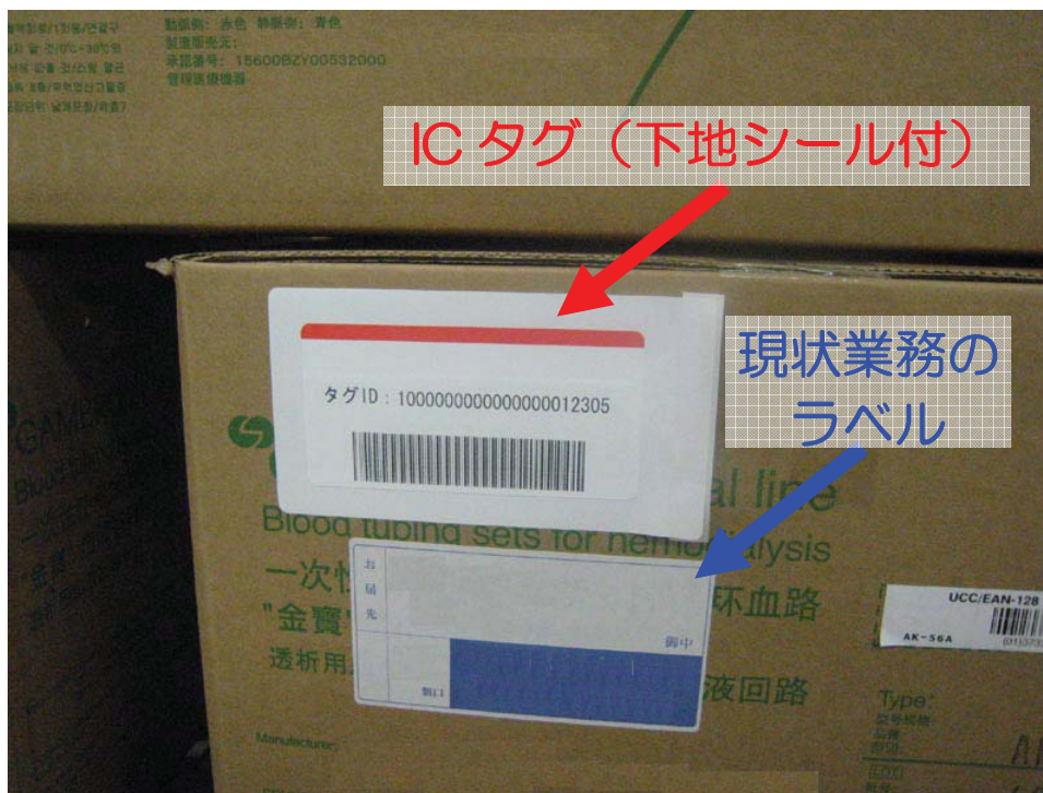
図 2-6 2 IC タグの貼付位置 (現状業務で利用しているラベルと同じ面に貼付)
