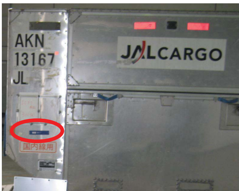
図 2-58 金属面の反射の影響を大きく受けるコンテナタグの貼付位置
