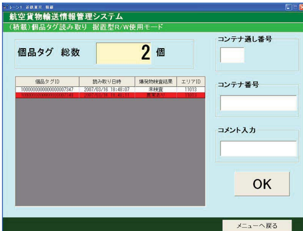
図 2-47 コンテナへの貨物積載時の読取画面（据置型 R/W 使用時）
