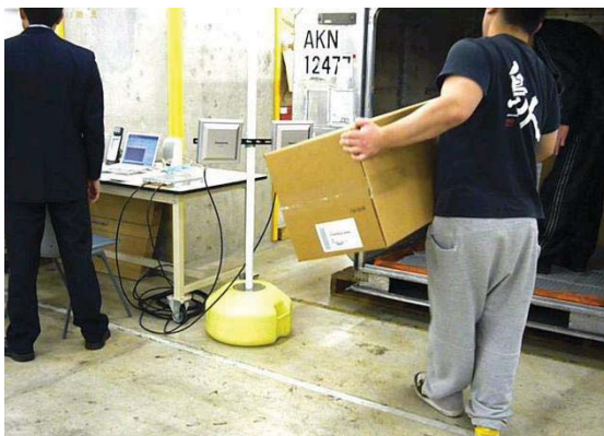
図 2-69 改良後のアンテナの向き（左）と上から見た模式図（右） （コンテナ入口垂直方向から見て斜め 45 度の向きに設置）
