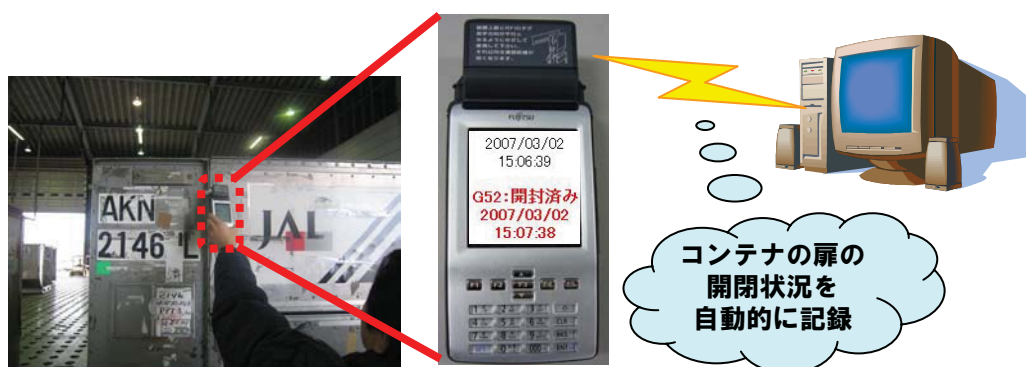
図 3-7 IC タグのシールによる開扉状況の把握
