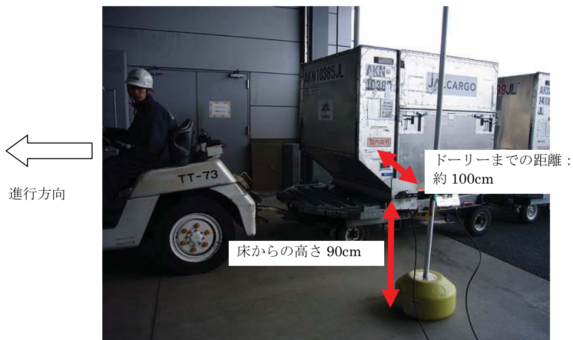
図 2-7 3 JAL 福岡貨物ターミナルにおける据置型 R/W 設置
