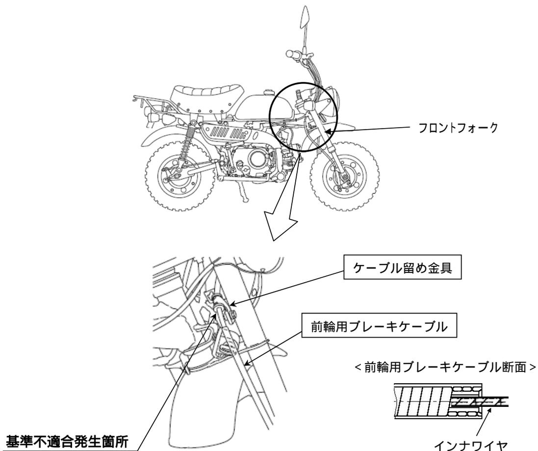
前輪用ブレーキケーブルの長さが不適切なため、走行中のフロントフォークの伸縮により、ケーブル留め金具部で当該ケーブルが折れ曲がることがある。そのため、そのまま使用を続けると、ケーブル内のインナワイヤが切損し、前輪ブレーキが操作できなくなるおそれがある。
