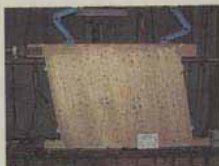
写真3 高さ1365mmの面材試験体の破壊状況
