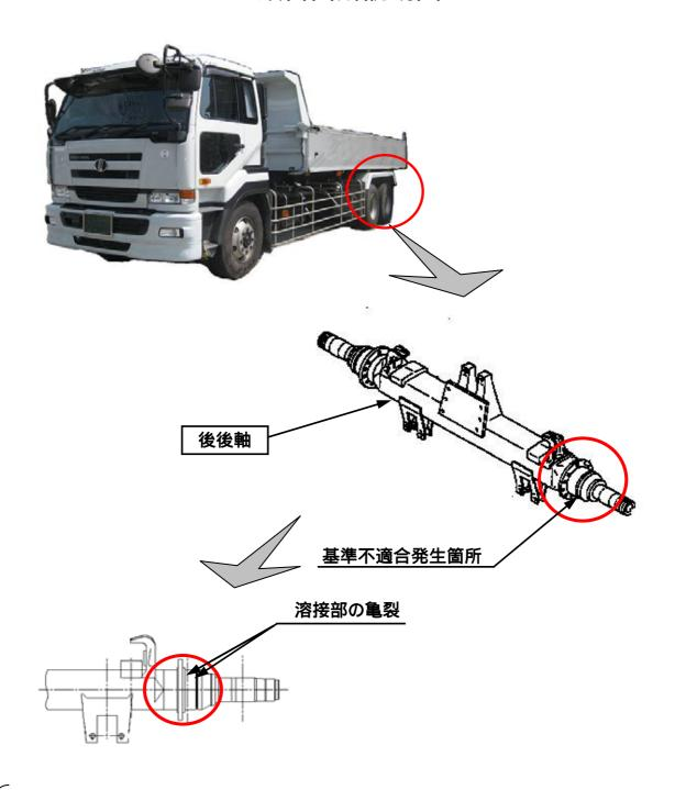
大型貨物車(後前1軸駆動3軸車)の後後軸において、一部の車両で、使用環境に対する強度の余裕が少ないため、当該車軸に亀裂が発生する場合がある。そのため、そのままの状態で使用を続けると、亀裂が進行し、最悪の場合、車軸が折損するおそれがある。
