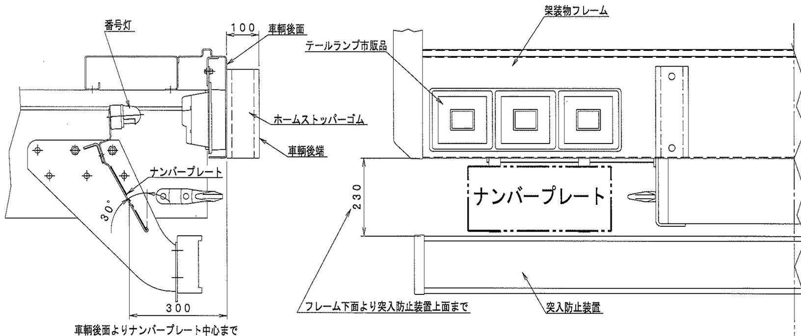
※荷台と突入防止装置との間にナンバープレートを取り付ける場合
