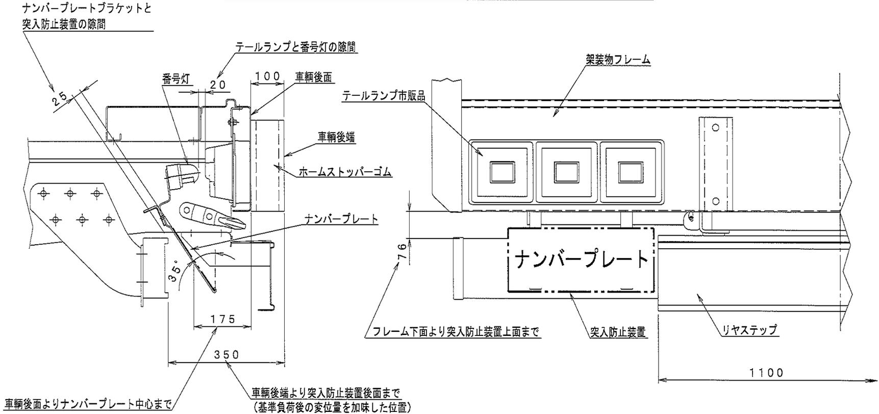
※荷台と突入防止装置との間が狭く、突入防止装置より後部にナンバープレートを取り付ける場合
