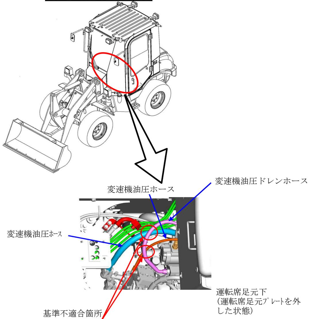
変速機油圧ホースにおいて、ホース間の隙間が少ないため、振動により当該ホース同士が干渉する場合があります。そのため、そのままの状態で使用を続けると、変速機油圧ホースが損傷し、最悪の場合、走行不能になるおそれがあります。
