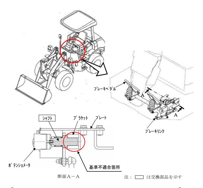
ブレーキペダルの踏み込み量を計測するポテンショメータにおいて、取付けシャフト の支持方法が不適切なため、当該シャフトが滑らかに動かないものがある。そのた め、そのままの状態で使用を続けると、ブレーキ操作後にペダルが戻らず、走行不能 になるおそれがある。
