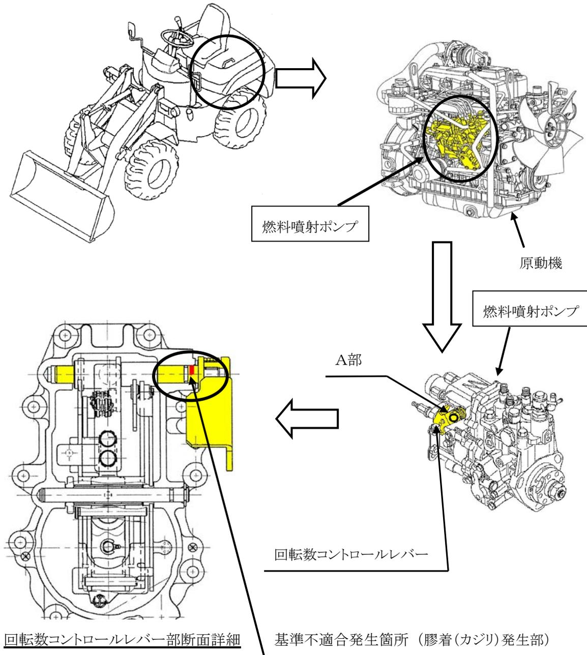
燃料噴射ポンプの回転数コントロールレバー軸の軸受けの材質及び当該軸と軸受けの隙間が不適切なため、アクセル操作を繰り返すと当該軸と軸受け部が膠着し、アクセルペダルを戻してもレバーの戻りが不十分となるものがある。そのため、原動機の回転数が下がらなくなるおそれがある。
