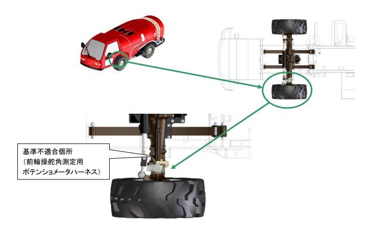
農業用薬剤散布車のかじ取り装置において、前輪操舵角測定用ポテンショメータのハーネスの配索が不適切なため、使用過程において、当該ハーネスが損傷する場合がある。そのため、4輪操舵時に後輪のかじ取り操作が適切に行なわれず、車両の操作性が損なわれるおそれがある。
