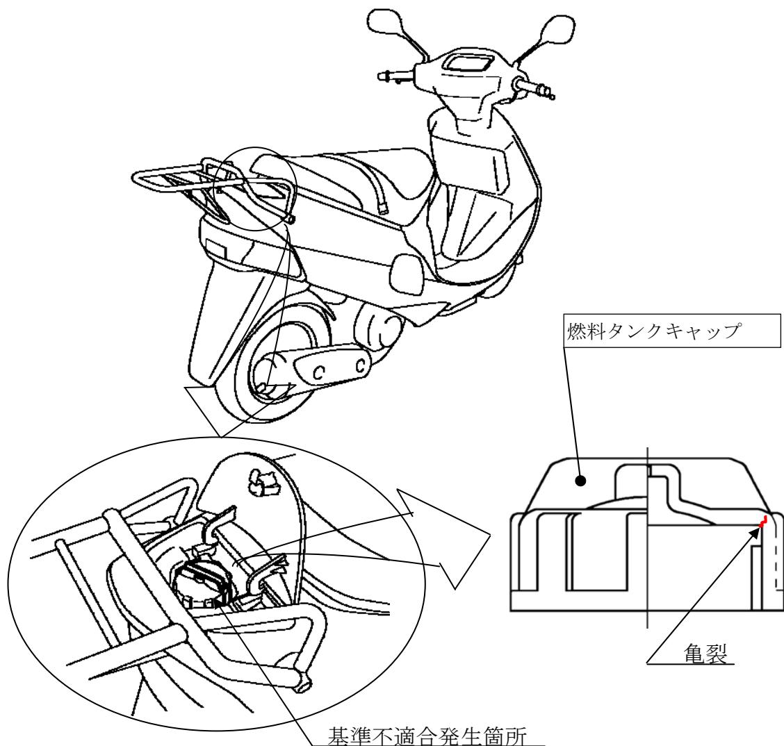
燃料タンクキャップの形状が不適切なため、亀裂が発生するものがある。そのため、開閉操作の繰り返しにより当該キャップの亀裂が進行し、そのまま使用を続けると燃料が漏れるおそれがある。
