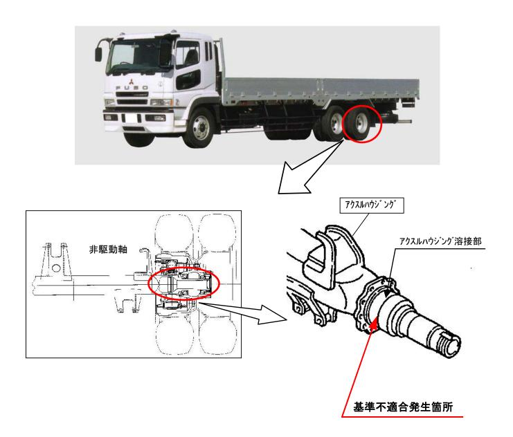
後2軸大型トラックの後々軸(非駆動軸)アクスルハウジングの製造が不適切なため、当該溶接部に 亀裂が発生するものがある。そのため、そのままの状態で使用を続けると、最悪の場合、当該アクスル ハウジングが折損し、ブレーキの過熱やタイヤとフレームの接触が生じて、火災に至るおそれがある。
