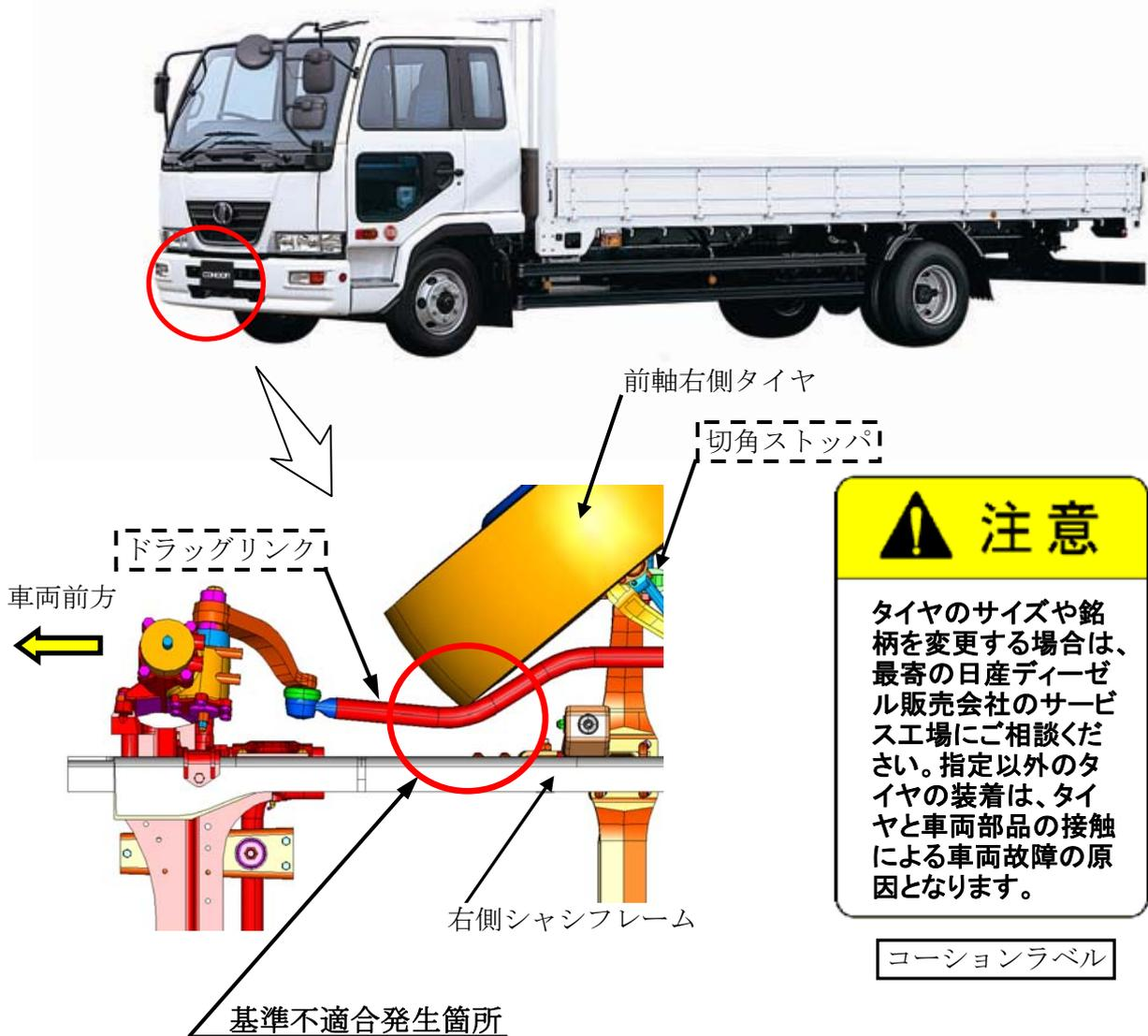
タイヤの切角が不適切なため、スタッドレスタイヤを装着してハンドルを最大限度まで切った状態で走行した場合、タイヤがドラッグリンクと接触することがある。そのため、そのままの状態で使用を続けると、当該リンクの接触部分に錆が発生し、損傷するおそれがある。
