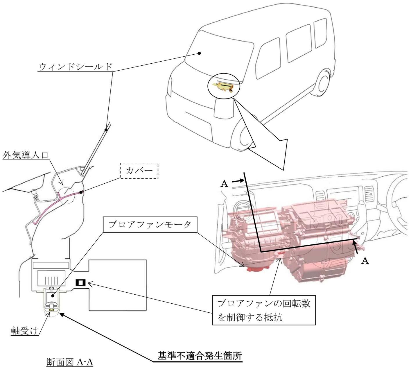
エアコンの外気導入口の構造が不適切なため、雨水がブロアファンモータ部に浸入し、当該モータの軸受けが錆びて固着するものがある。そのため、ブロアファンモータが停止してデフロスタが作動しなくなる。また、マニュアルエアコン仕様においては、ブロアファンの回転数を制御する抵抗のヒューズが熔断せず、最悪の場合、火災に至るおそれがある。
