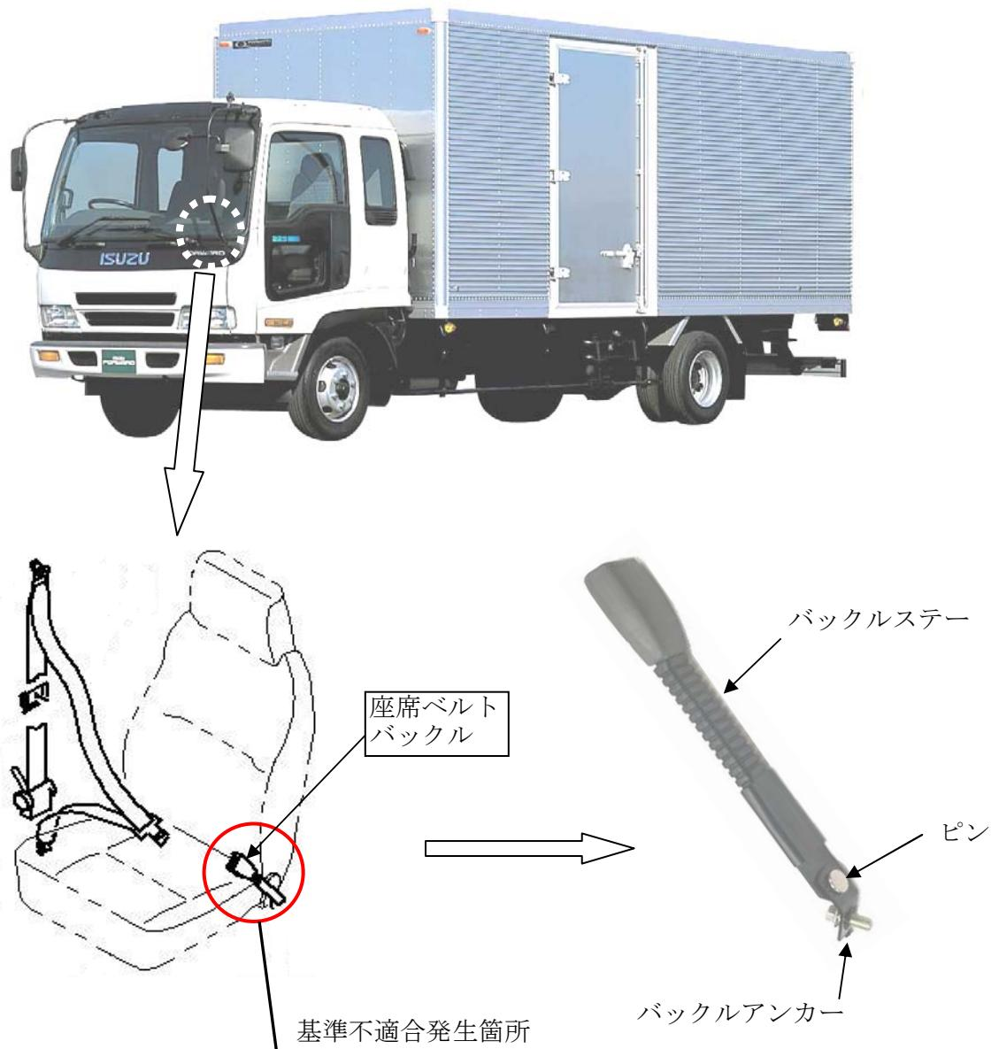
交換修理用として販売した運転席用の座席ベルトバックルにおいて、バックルステーとバックルアンカーを固定しているピンに不適切な材料を使用したため、当該ピンに亀裂が生じているものがある。そのため、そのままの状態で使用を続けると、当該バックルが外れるおそれがある。
