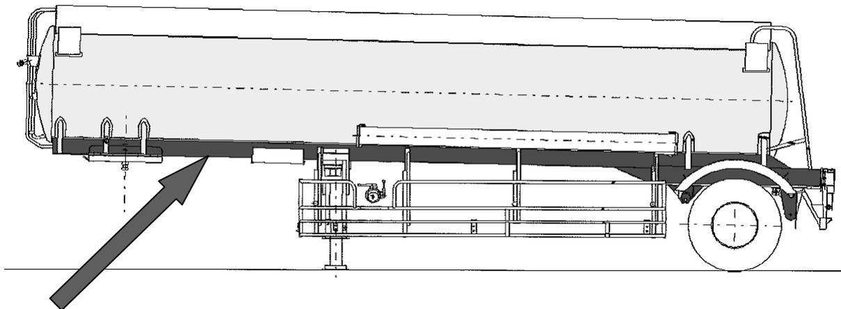
フレームの断面形状を変更したにもかかわらず、事前に必要な改造自動車届出を行わずに新規検査を受検
