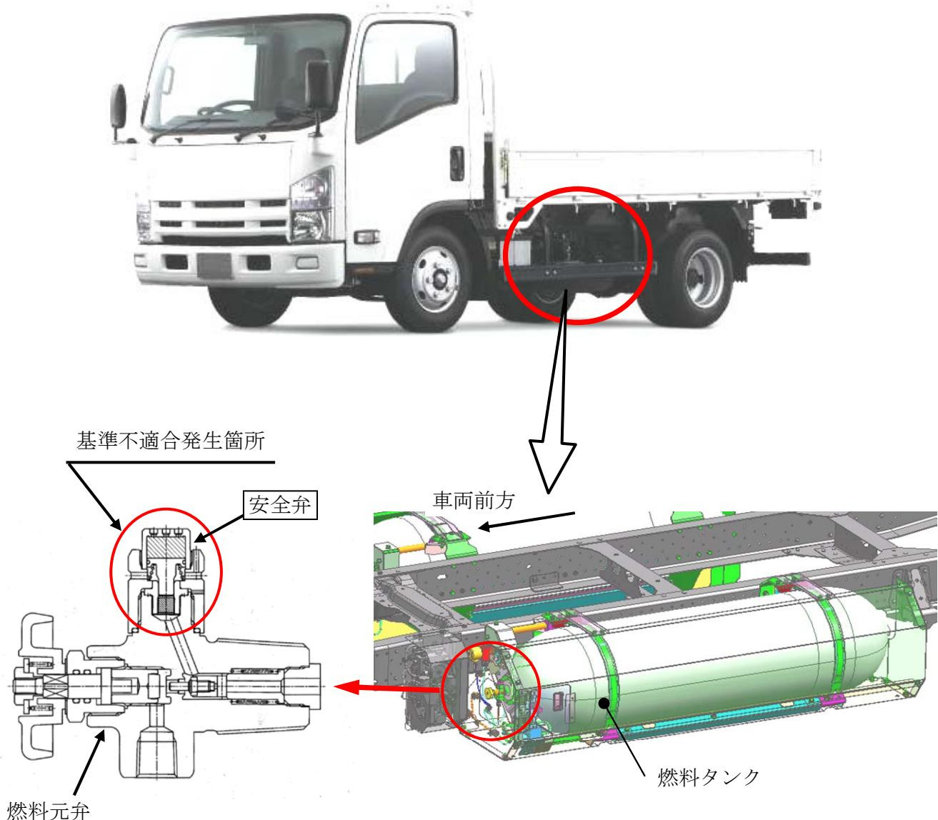
圧縮天然ガス自動車（CNG車）において、燃料タンク安全弁の材質に対して、組立て工場の燃料充填方法が不適切なため、安全弁内部に亀裂が生じる場合がある。そのため、そのままの状態で使用を続けると、亀裂が進行し、燃料が漏れるおそれがある。
