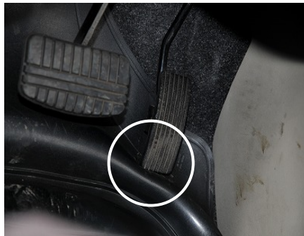
自動車 B の干渉再現状態 (フランジ付きマット・フロント用)
