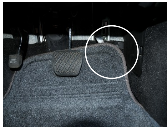
自動車Dのフロアマット被さり再現状態 (フランジ付きマット・フロント用：この状態でブレーキを踏むと同時踏みとなる)
