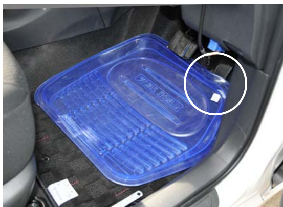
自動車Cのフロアマット被さり再現状態 (フランジ付きマット・リア用：この状態でブレーキを踏むと同時踏みとなる)
