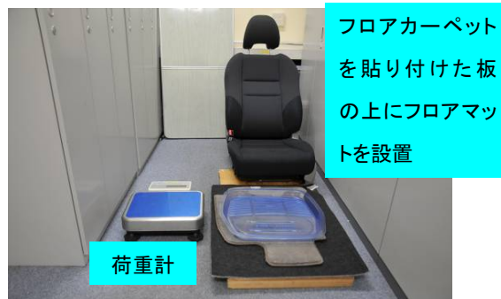
写真3-2 運転席を模擬したレイアウト
