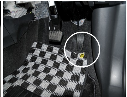
自動車 C の干渉再現状態 (フラットマット・フロント用)
