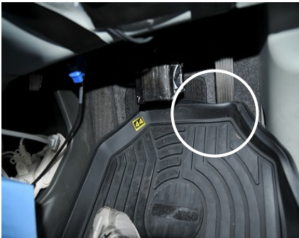
自動車 A の干渉再現状態 (フランジ付きマット・リア用) 注:外気温 2~3℃時に再現したが 温度が上がると剛性が低下して干 渉は再現しなくなった
