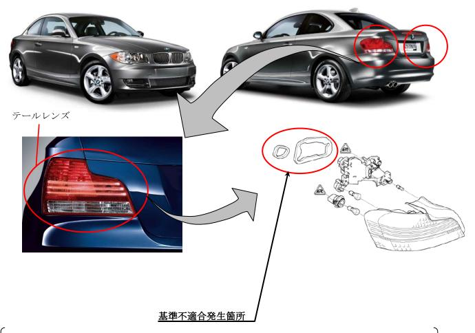
テールレンズのシーリング材が不適切なため、シーリング材の気化成分により発光ダイオード (LED) の電気基板の接続部が腐食して、接触不良をおこすことがある。そのため尾灯および 駐車灯が点灯しないおそれがある。
