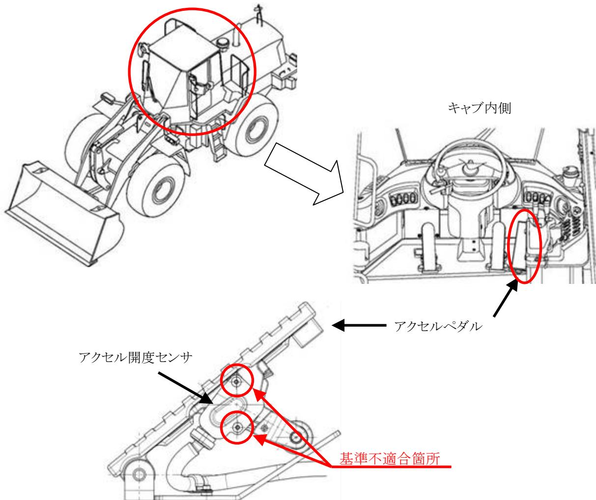
〔 アクセルペダルに備えられているアクセル開度センサにおいて、取付けボルトの締付けトルクが不足しているものがあるため、そのままの状態で使用を続けると当該センサが脱落し、最悪の場合、アクセルペダルを踏んでもエンジン回転が上がらなくなるおそれがある。 〕
