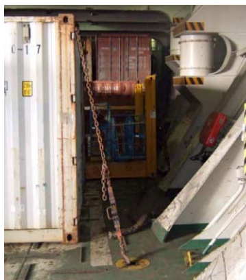
チェーンによるコンテナの固縛
