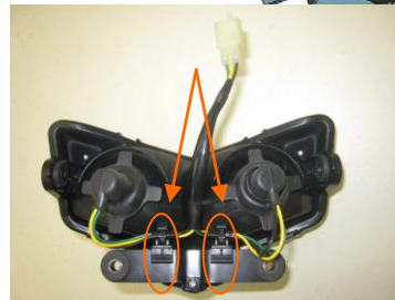
※電球用電気配線を固定
