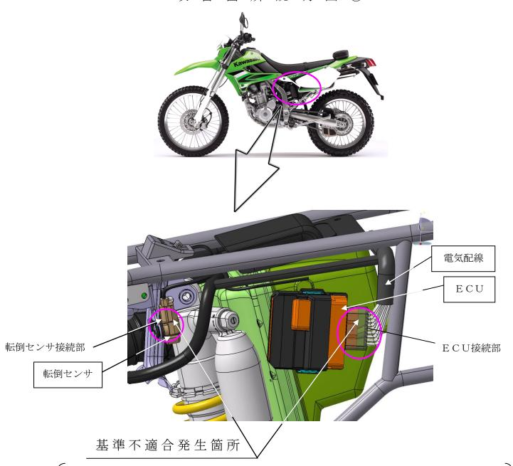
燃料噴射用電子制御コントロールユニット(ECU)及び転倒センサにおいて、ECUと転倒センサ間の電気配線の防水対策が不十分なため、洗車時または雨天走行時の被水により水が当該電気配線内を伝わり、ECU及び転倒センサと電気配線の接続部に浸入する場合がある。そのため、そのままの状態で使用を続けると、当該接続部の端子が腐食して導通不良となり、最悪の場合、エンジンが停止するおそれがある。
