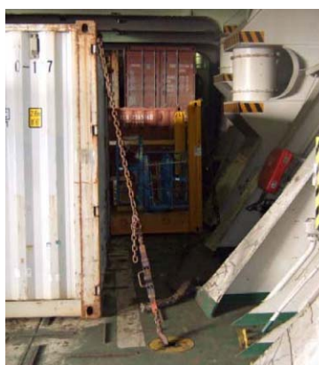
チェーンによるコンテナの固縛
