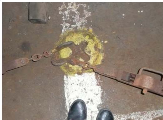
クローバーリーフにフック形式の固縛装置を掛けている例 (強度不足となる可能性があり不適切)
