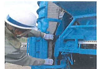
低い位置に固定したホッパーから砕石を連続投入可能
