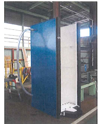
調査のために使用する小型の止水箱(ドライボックス)
