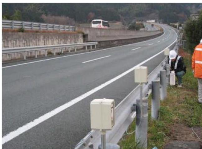
可搬式トラフィックカウンター(車両感知器)
