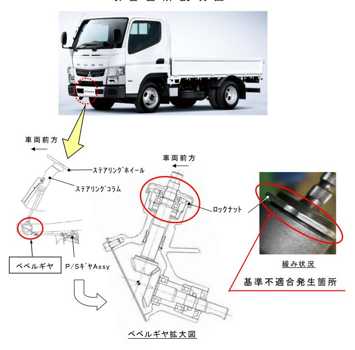
かじ取り装置において、製造工程の管理が不適切なため、操舵力を伝える歯車を固定するナットの締付けが不十分なものがある。そのため、そのままの状態で使用を続けると、当該ナットが緩み、操舵不能となるおそれがある。
