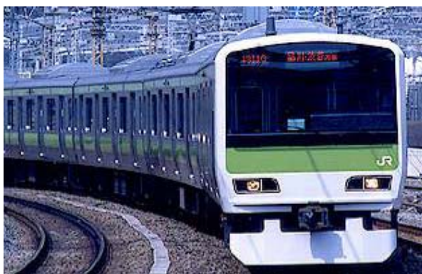
E231系 (1999) VVVF制御 回生ブレーキ
