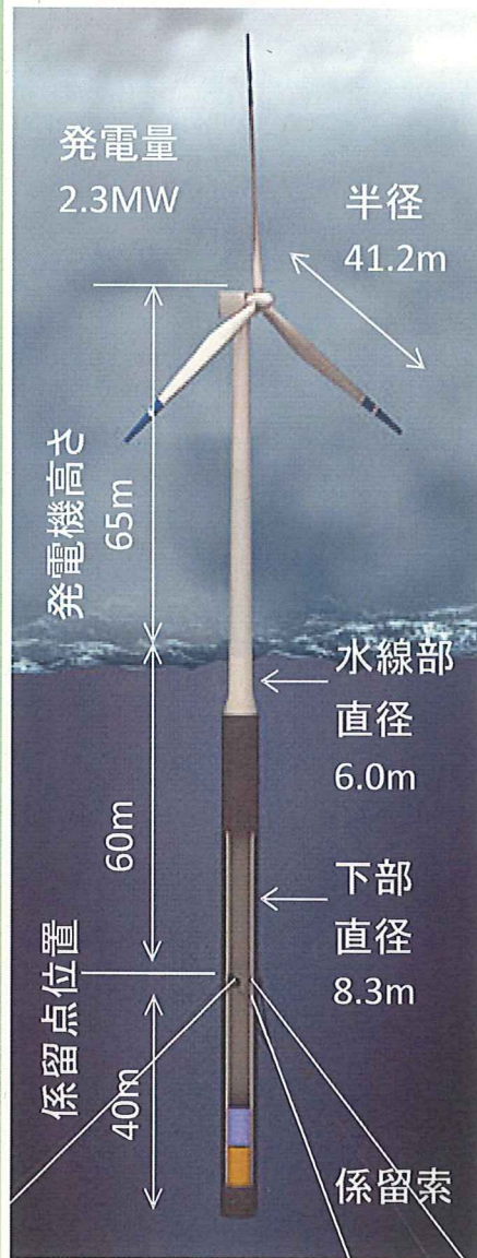
浮体式洋上風車の例
