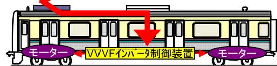
電力回生ブレーキ ブレーキ中の車両が発生した電力を架線に戻し、力行中の車両がその発生した電力を利用する方式
