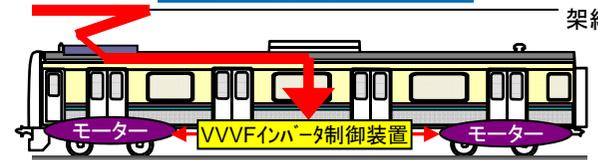
VVVFインバータ制御 抵抗器を使わずにモーターの回転数を効率良く制御する機構
