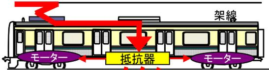
抵抗器を使ってモーターを制御しているため、無駄な熱エネルギーが発生
