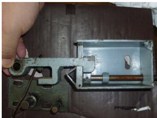
(写真 I-9) 事故当時使用されていた施錠装置
