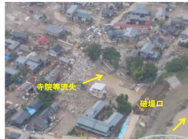
堤防決壊時の甚大なエネルギーにより26戸の家屋等が流失
