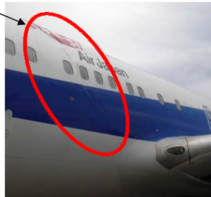
機体胴体部外板の変形(側面)
