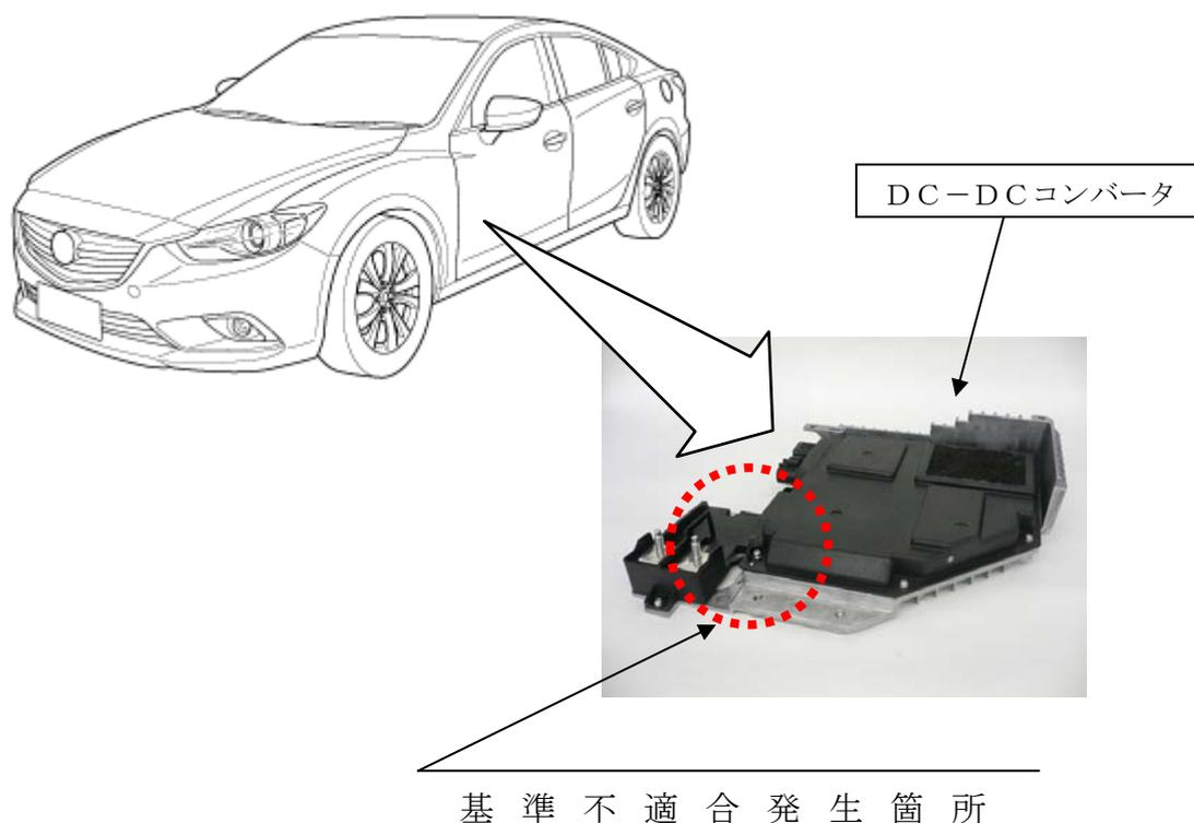
DC-DCコンバータの製造工程において、電子基板上のコンデンサに亀裂が入っているものがあり、当該コンデンサがショートする可能性がある。そのため、DC-DCコンバータが溶損し、最悪の場合、火災に至るおそれがある。
