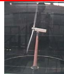
浮体式洋上風車の風洞試験
