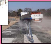
大型車による衝突実験
