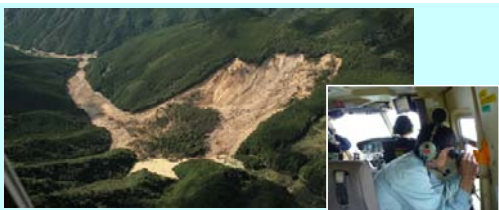
台風12号で発生した天然ダム(熊野)とヘリからのレーザー距離計による地形計測
