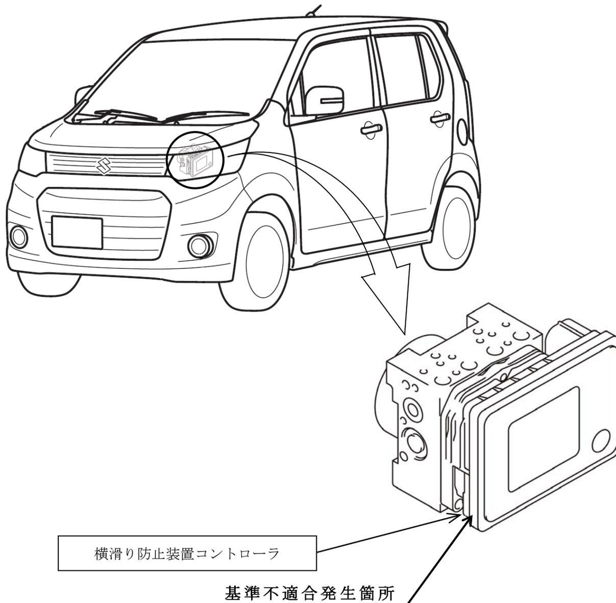
四輪駆動の横滑り防止装置付仕様車において、横滑り防止装置コントローラに二輪駆動仕様の制御プログラムを誤って書き込んだため、凍結した路面等でゆっくりと制動したときにABS（アンチロックブレーキシステム）が作動せずに車輪がロックし、車両安定性が損なわれるおそれがある。
