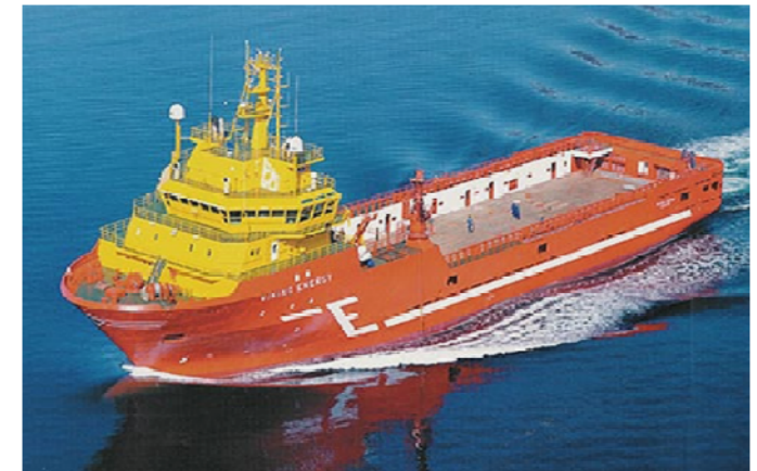
Eidesvik社 Viking Energy (オフショアサポート船、DFタイプ、船長95m)
