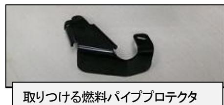
原動機室内に燃料パイププロテクタが装着されていない車両について、衝突時の燃料漏れのおそれをより少なくするため、燃料パイププロテクタを追加する。(基準不適合ではないが、安全性向上を目的とするもの)
