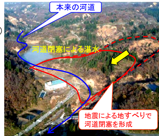
H16年新潟県中越地震で形成された信濃川水系芋川の河道閉塞
