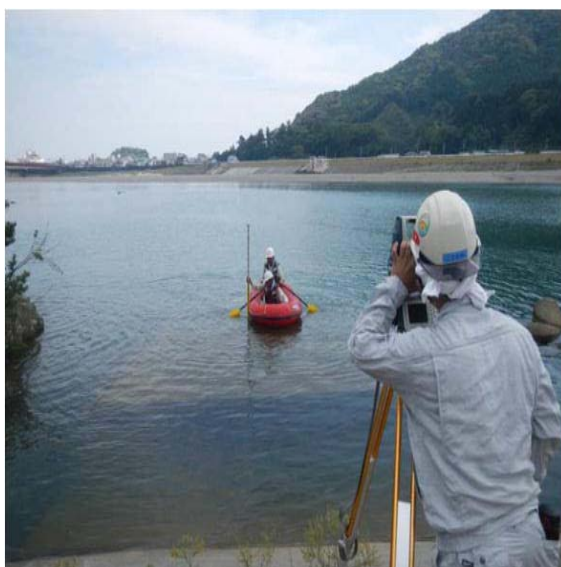
局所洗掘調査
