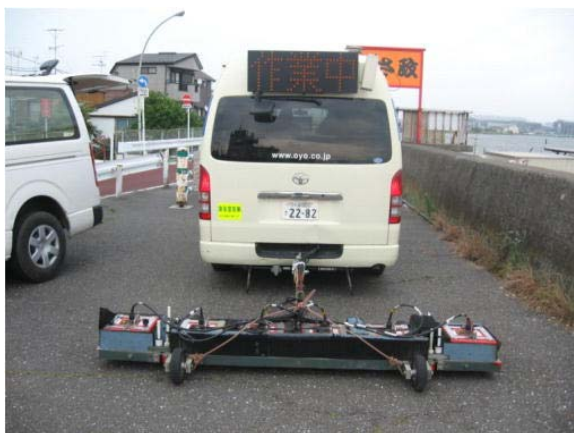
管理用道路下の空洞化調査
