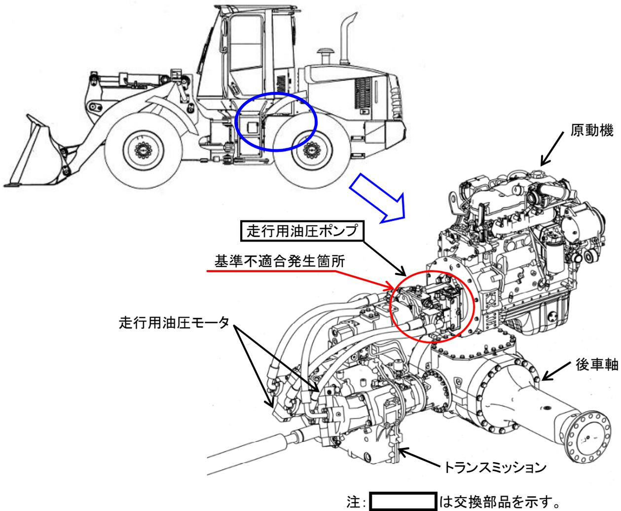
当社ショベルローダに搭載している走行用油圧ポンプにおいて、内部のベアリング保持器を支えているピンが使用条件により磨耗する場合がある。そのままの状態で使用を続けると当該ピンが折損し、ベアリング保持器が正常に保持されなくなり、最悪の場合、ベアリングが破損することで油圧ポンプが正常に作動しなくなり、走行不能に至るおそれがある。
