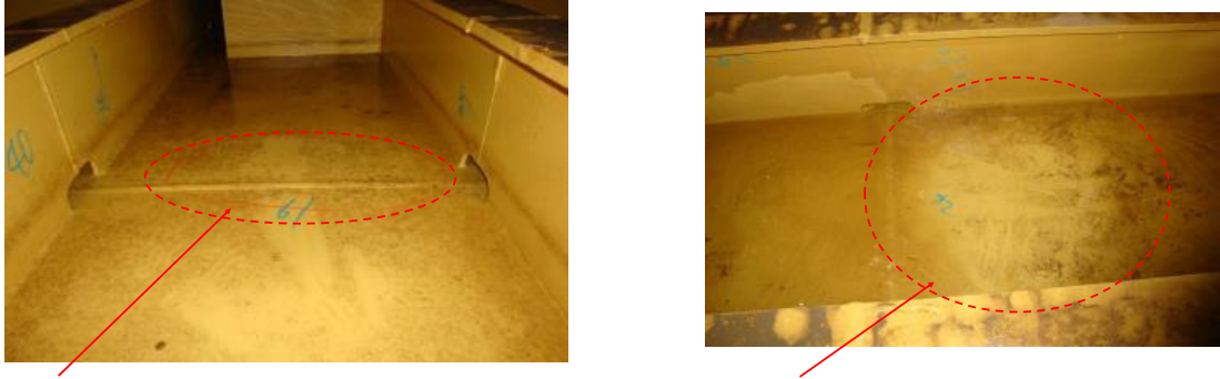
図 4. 4 事故船の船底外板変形（No.5 Cargo Hold 下の船底外板 Fr.182 近傍のバット継手部付近） （商船三井提供）
