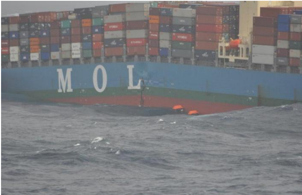
図3. 2 拡大図：亀裂の進展方向（商船三井提供）
