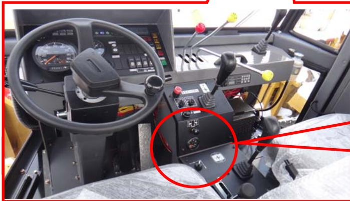
制動装置空気用圧力計
